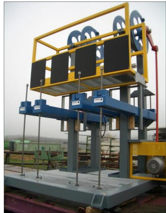
Unsere Bilder zeigen die Schairer-Belegschaft im Jubiläumsjahr, einen mobilen Getriebeprüfstand (Nutzlast 35 Tonnen für ZF Passau) sowie eine Vierfach-Seilprüfmaschine fürs Institut für Fördertechnik in Stuttgart.
